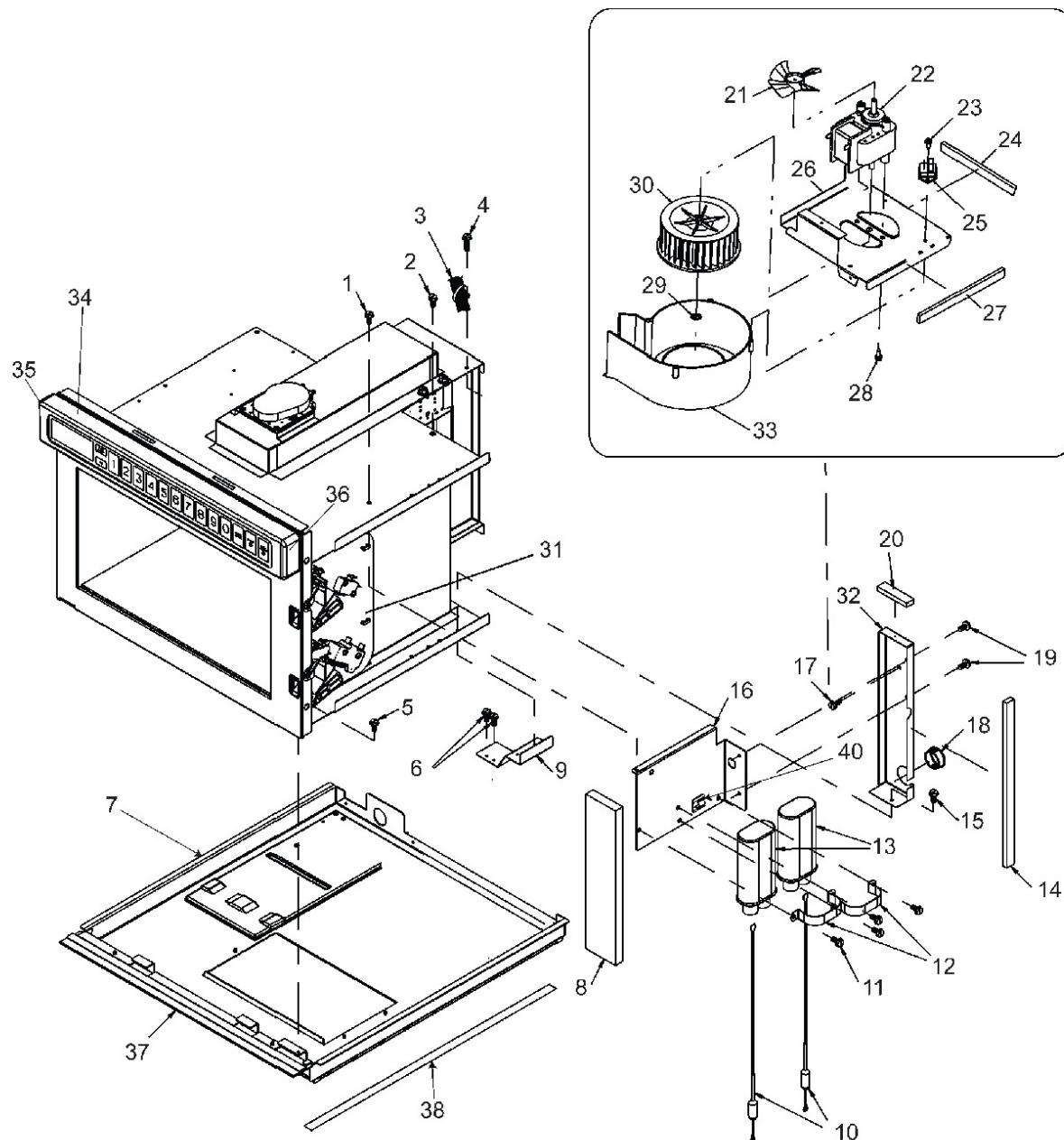
**BLOWER, CAPACITOR, DIODE, INTERLOCK**
