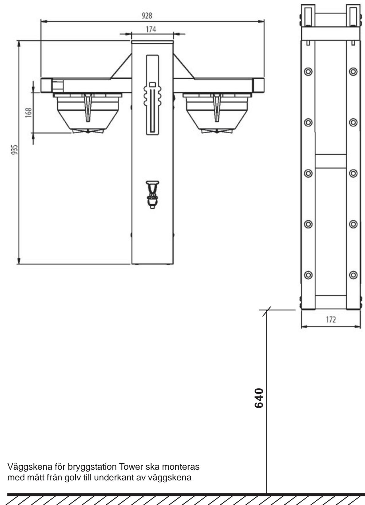
Väggskena för bryggstation Tower ska monteras med mått från golv till underkant av väggskena
