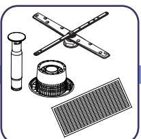
检查清洗/喷淋臂、溢流管、过滤网是否安装到位
