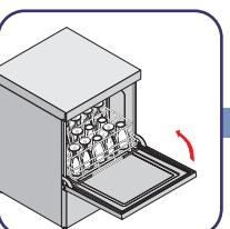
将筐放入机器中，关闭机门
